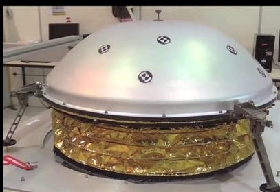
Le sismomètre posé à même le sol sera recouvert d'un bouclier de protection qui isolera la sonde du vent et renforcera la protection
