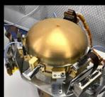
Une sphère garantissant le vide protège les capteurs très large bande des variations thermiques, de pression et permet ainsi de détecter des mouvements du sol de l'ordre de la taille d'atomes d'hydrogène.
