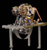
SEIS est constitué de trois pendules très large bande VBB capable de mesurer les mouvements verticaux et horizontaux du sol martien.
