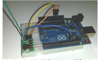
Réaliser le transfert du programme 'Emission' (vers l'arduino UNO) à l'aide de l'IDE Arduino.
