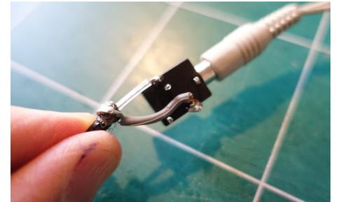
Câble coaxial relié au capteur piézoélectrique
