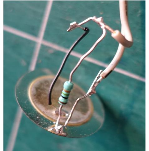
Capteur piézoélectrique et résistance de  $1\text{ M}\Omega$
